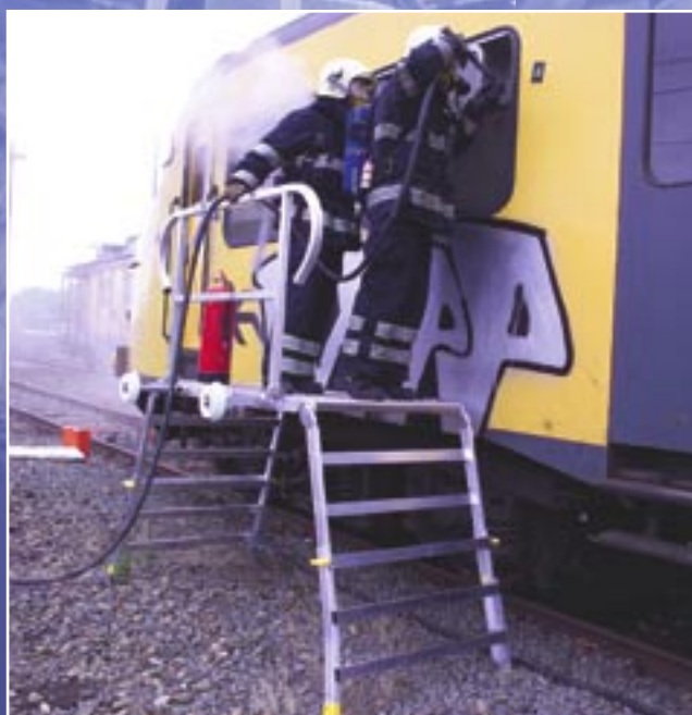
Het reddingsplatform is een ideaal hulpmiddel voor bluswerkzaamheden bij treinstellen.
