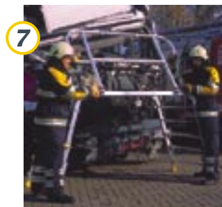
7 De leuning wordt opgeklapt (kan ook aan de andere zijde worden geplaatst).
