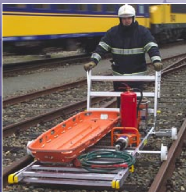
Met behulp van de optionele platformwielen zijn bij calamiteiten op het spoor reddingsgereedschappen en materialen snel en efficiënt te transporteren.
