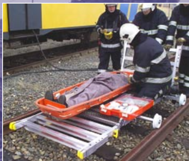
Met de optionele platformwielen is het reddingsplatform snel omgebouwd tot een reddings- en vervoer trolley.
